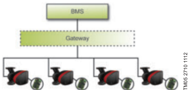
Рис. 7 Пример системы управления внутридомовыми коммуникациями (BMS)
